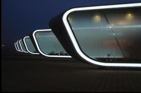
Projekt: ZOB Halle Aufgabe: Konturenbeleuchtung Lösung: LED Modulkette IP67
